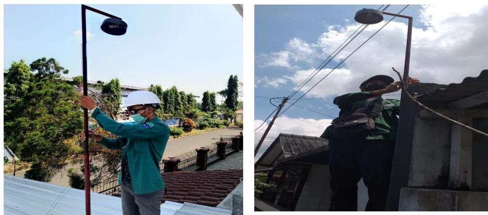
Gambar 3.13. Pemasangan *passive sampler*
