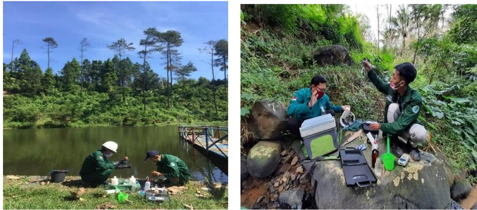
Gambar 3.12 pengambilan sample air untuk uji kualitas air
